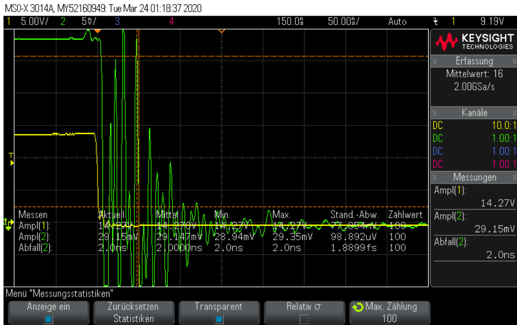
Figure 21: Rein ohmscher Teiler - niederohmig ( Z_{HS} : 1.02 k \Omega , Z_{NS} : 2.15 \Omega , gelb: U_{HS} mit 5V/dec und 150ns/dec, grün: U_{NS} mit 5mV/dec und 50ns/dec, DC-Kopplung, Tastkopf 1:1, DSO-Impedanz: 1 M \Omega )
