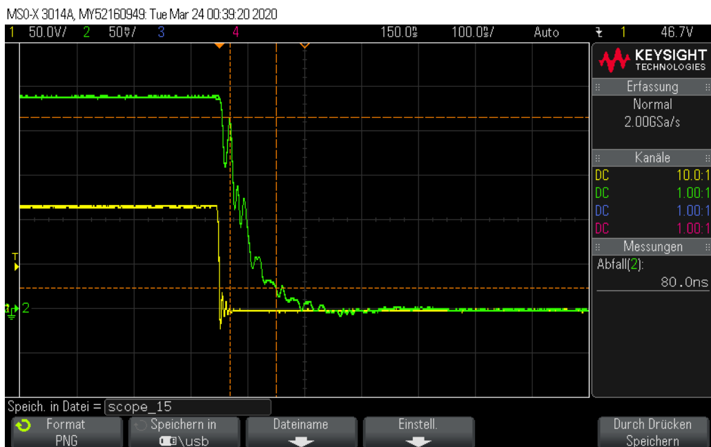
Figure 18: Rein ohmscher Teiler - niederohmig ( Z_{HS} : 16.5 k \Omega , Z_{NS} : 36 \Omega , gelb: U_{HS} mit 50V/dec und 150ns/dec, grün: U_{NS} mit 50mV/dec und 5 \mu s/dec, DC-Kopplung, Tastkopf 1:1, DSO-Impedanz: 1 M \Omega
