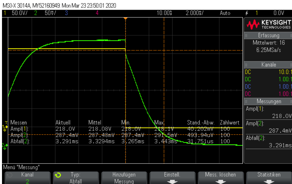
Figure 14: Rein ohmscher Teiler - hochohmig ( Z_{HS} : 756 \text{ M}\Omega , Z_{NS} : 1 \text{ M}\Omega , gelb: U_{HS} mit 50\text{V}/\text{dec} und 10\text{ns}/\text{dec} , grün: U_{NS} mit 50\text{mV}/\text{dec} und 5\mu\text{s}/\text{dec} , DC-Kopplung, Tastkopf 1:1, DSO-Impedanz: 1 \text{ M}\Omega )
